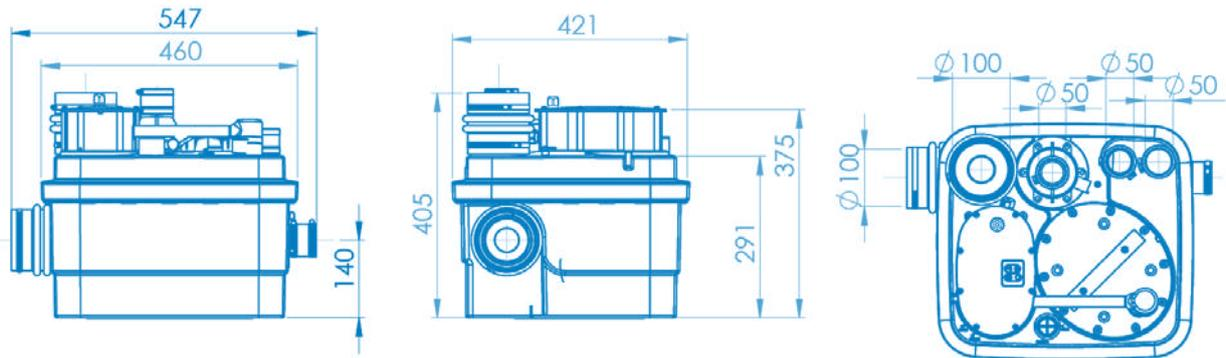
Schéma d'encombrement SANICUBIC® 2 Classic – SANICUBIC® 2 Pro
