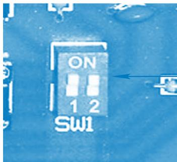
NB : Si les 2 switches sont abaissés (position off), situation anormale, la carte sera en mode alarme dès remise sous tension
