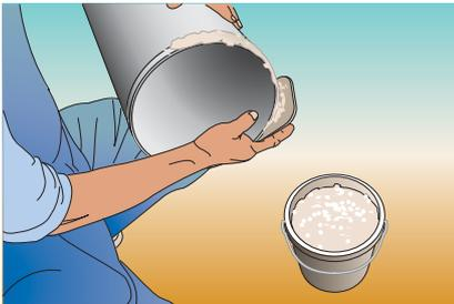
Lubrifier l'embout mâle sur toute la circonférence, principalement le chanfrein. Pour les gros diamètres il est parfois nécessaire de lubrifier également la partie apparente du joint, dans ce cas ne jamais mettre de pâte dans la gorge.
