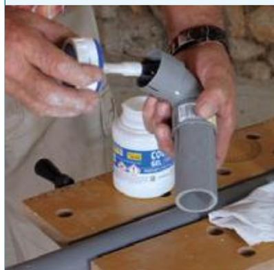
Poncer et nettoyer les zones de contact avec du décapant PVC puis appliquer la colle PVC.
