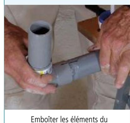
Emboîter les éléments du montage en veillant à bien respecter l'alignement des repères tracés à l'étape 2. Essuyer le surplus de colle et laisser sécher le montage.
